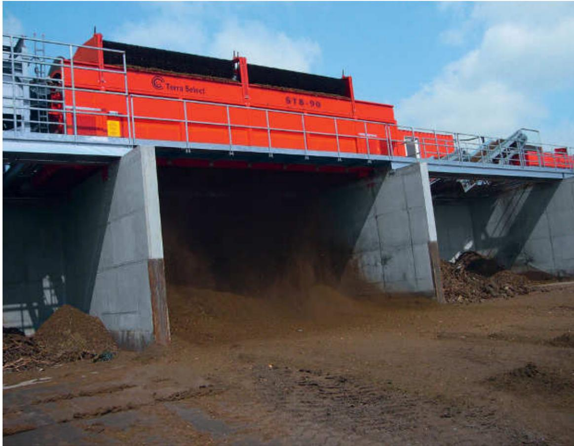
Línea de procesamiento de biocompost (criba de tambor, separación de piedras, separación de longitudes excesivas y separación por aire)
