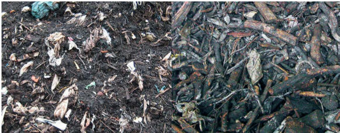
¿Ha encontrado la diferencia? Las fotos muestran el material retenido en la criba procedente del proceso de compostaje, antes del separador neumático (imagen izquierda) y después del separador neumático (imagen derecha).
